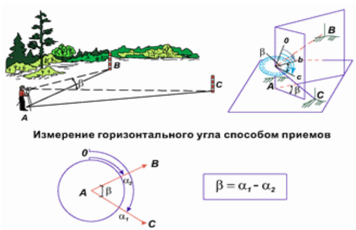
Рисунок - Измерение горизонтального угла Журнал измерения горизонтальных углов способом приемов
