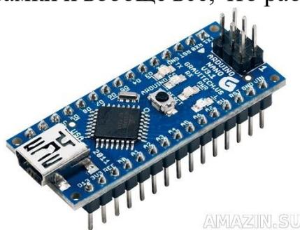
Рисунок 1 – Плата Arduino Nano
